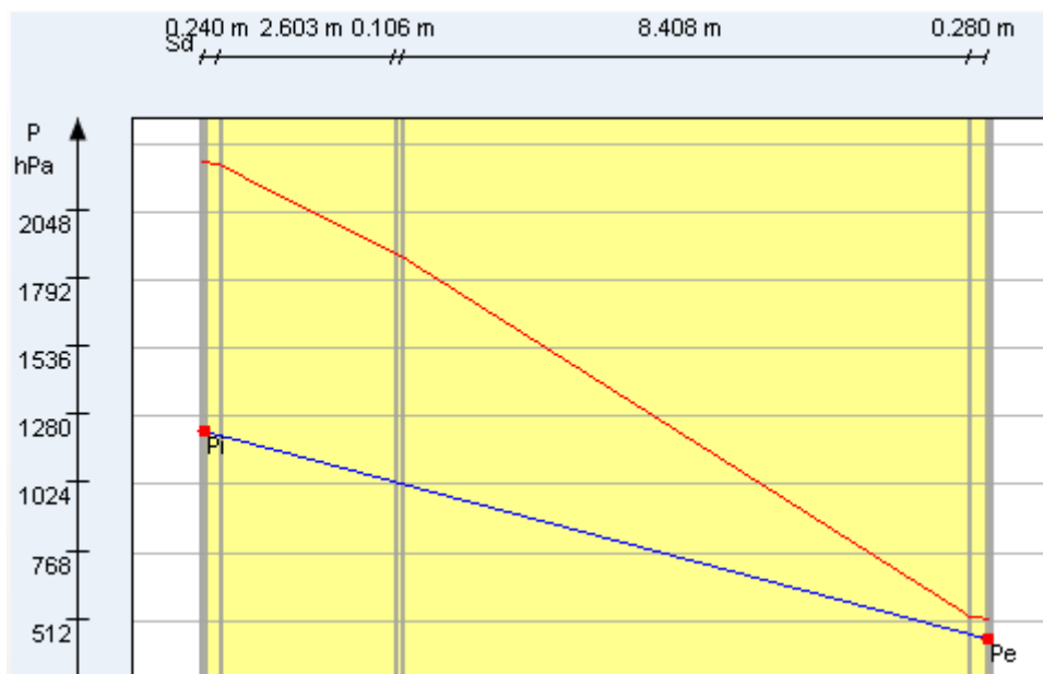
Rys. nr 19. Wykres prężności pary wodnej - sprawdzenie występowania kondensacji międzywarstwowej w projektowanej przegrodzie w miesiącu grudniu.
